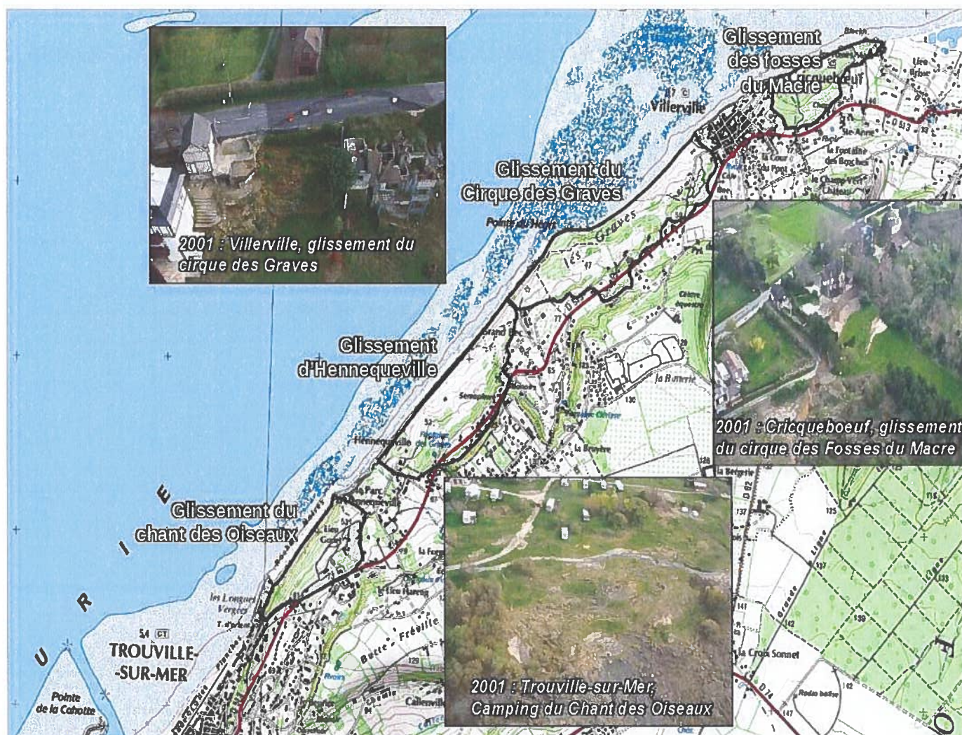
Figure 13: Localisation des grands glissements (source : SCAN 25® - © IGN Paris – Reproduction interdite) et photographies des phénomènes de 2001 (source : DIREN Basse-Normandie- SIDPC du Calvados)
